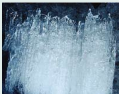
Reste de glace de lac à cristallisation en colonnes, fins monocristaux de 20 centimètres de long. Cliché L. Reynaud, Groenland.
